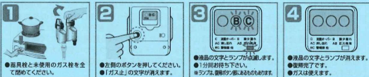
ガスの流れや、圧力などの異常やガス使用中に大きな地震があった場合など、マイコンメーターの安全機能が働きガスを自動遮断する場合がございます。その際は、マイコンメーター復帰方法にそって復帰ボタンを押してください。
