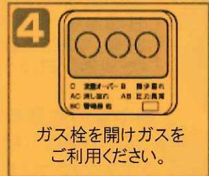
ガスの流れや、圧力などの異常やガス使用中に大きな地震があった場合など、マイコンメーターの安全機能が働きガスを自動遮断する場合がございます。その際は、マイコンメーター復帰方法にそって復帰ボタンを押してください。ガス漏れがないかマイコンメーターが安全確認を行い、異常がなければ、ガス止表示と赤く点滅しているランプが消えガスが使用できるようになります。復帰できない場合は復帰を繰り返さずにご連絡下さい。点検に伺います。
